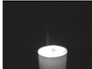
รูปที่ 3 การผลิต non-thermal plasma จาก DBD
